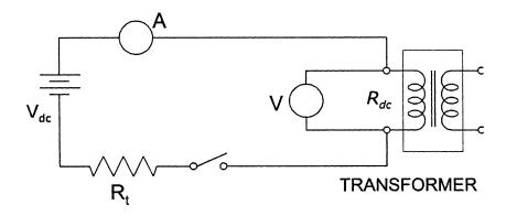
Figure 3.3 Voltmeter-Ammeter Method
